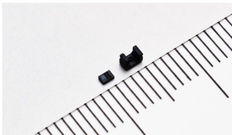
左：反射形フォトインタラプタ<GP2S800シリーズ>、右：透過形フォトインタラプタ<GP1S396シリーズ>
